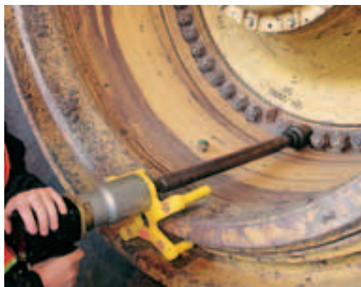
Mit dem 400 SLA-Luftschauber sind die vielen Schrauben beim Radwechsel eines Muldenkippers schnell und bequem gelöst und festgezogen.
