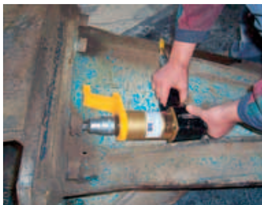
Der 340 SL verschraubt hier ohne Mühe 3000 Nm Innensechskant-Schrauben SW 19 an einem Anbauhammer.
