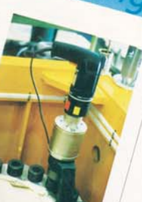
Es geht auch elektrisch: Montage eines Pressenzylinders mit dem „TE 1000“ von Sit.
